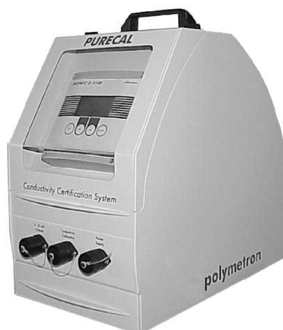
PURECAL est un banc portable permettant d'étalonner rapidement et précisément les chaînes de mesure de conductivité en ligne, par utilisation directe du liquide du process et comparaison avec notre système de référence.
