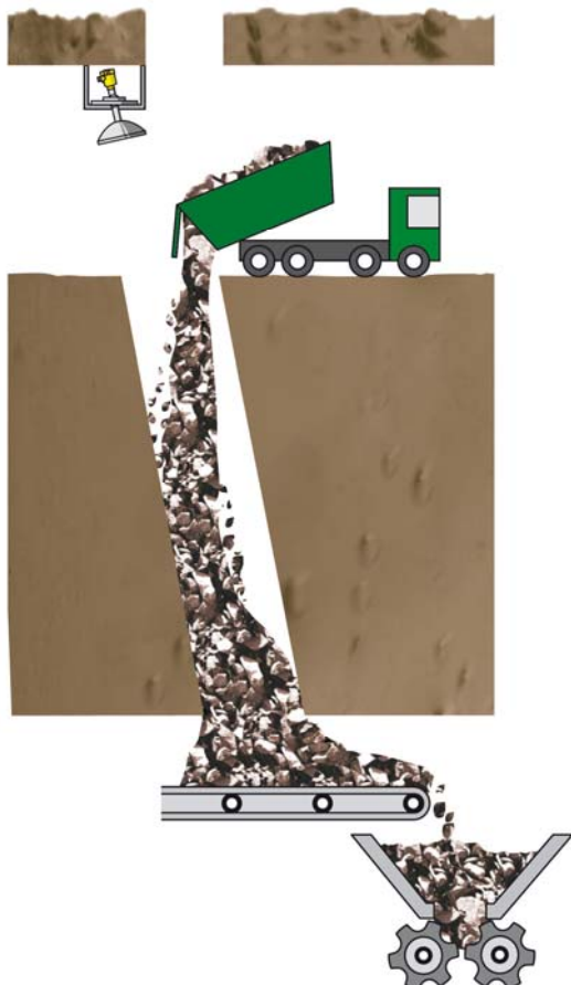
Capteur de niveau radar avec antenne parabolique pour un très faible angle de mesure de 4°.
