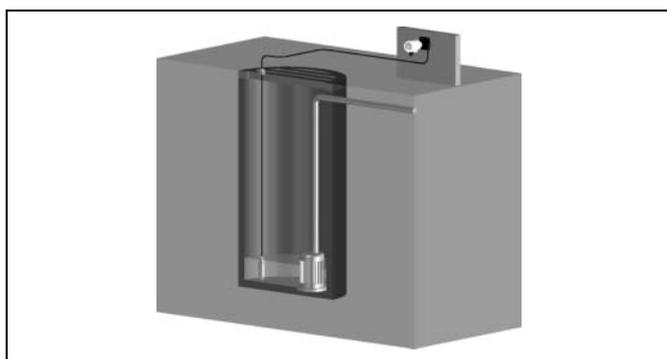
Fig. 7: Version avec câble porteur dans un puits d'épuisement
