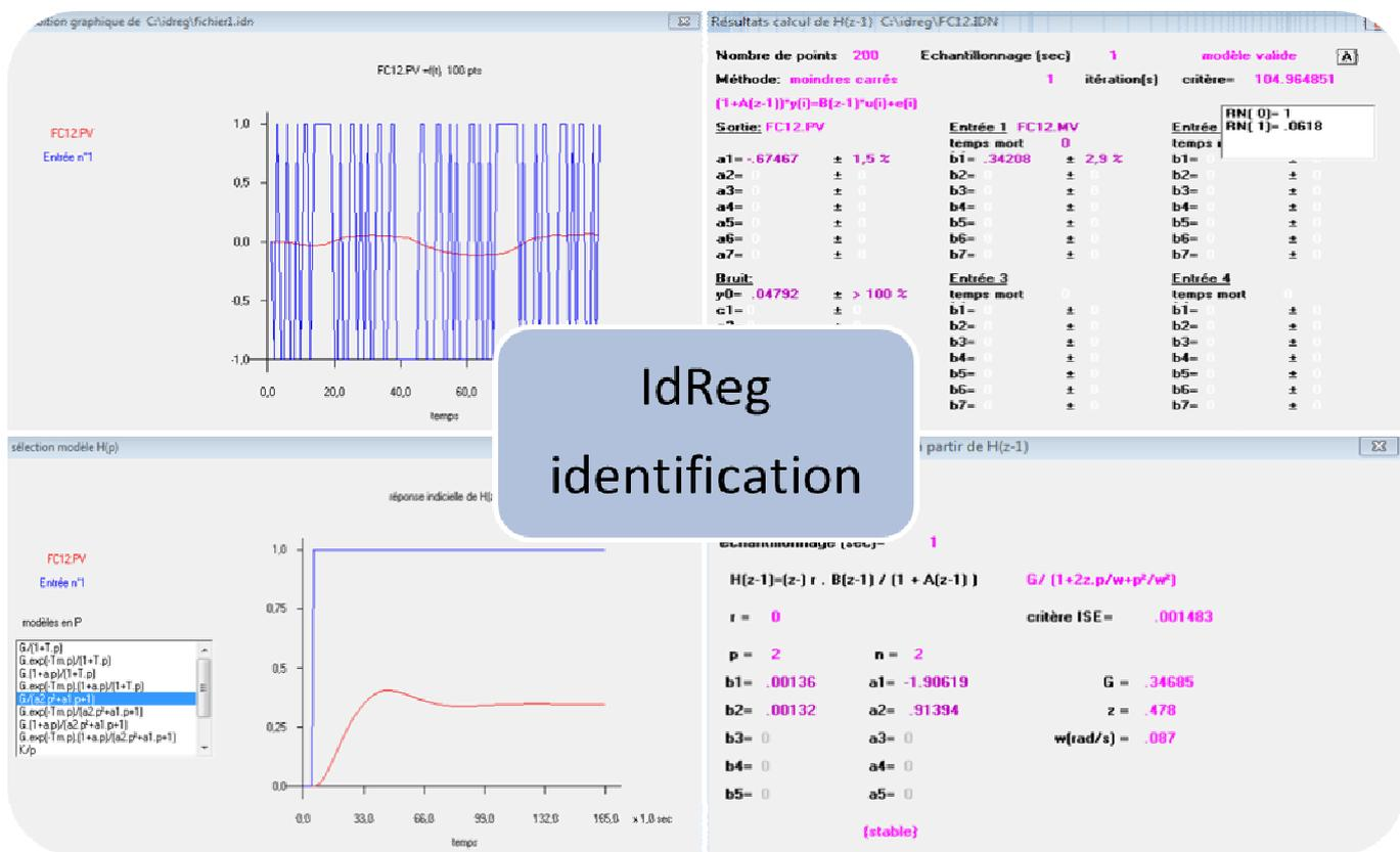
**IdReg** est un logiciel d'identification de procédés, de calcul des réglages et de simulation de boucles de régulation.
