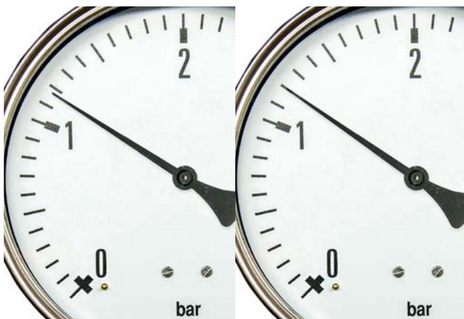
**L'indicateur de gauche sur l'image ci-dessous est difficile à lire correctement car l'indicateur se trouve entre les graduations de l'échelle, tandis que celui de droite est facile à lire car on a ajusté la pression appliquée de sorte que l'aiguille tombe exactement sur une graduation de l'échelle**
