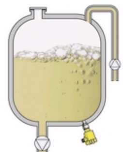
Mesure de niveau sur cuve d'eaux usées sans risque de colmatage
