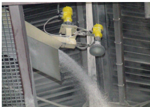
Mesure de niveau insensible à la poussière.
