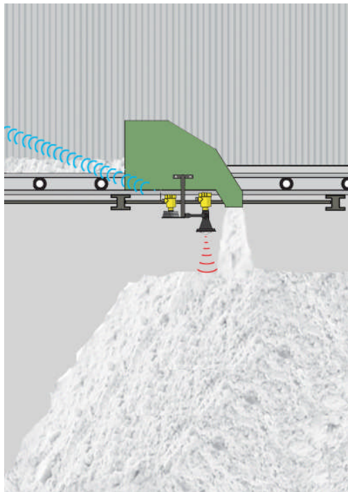
Mesure de niveau radar sans contact avec transmission du signal de mesure sans fil.
