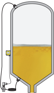
Montage à séparateurs et capillaires sur cuve de bière sous pression
